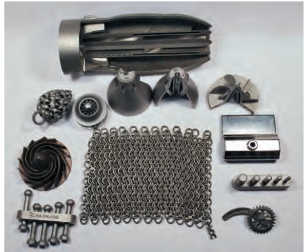
Metallien tulostamiseen soveltuvalla lasertulostimella valmistettuja metallikappaleita. (Kuva: Kirsti Nieminen)
