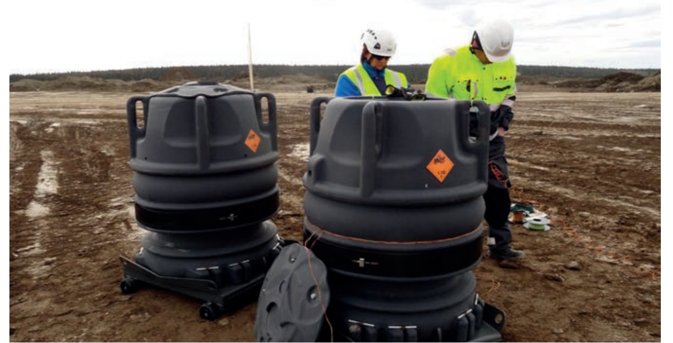
PM16-merimiinan välittymistestin valmistelua — räjäytettävää miinaa nallitetaan koetta varten PVTUTKL:n räjähdeiden käytöstä vastaavan johtajan valvonnassa. (Kuva: Marja-Leena Karisaari)
