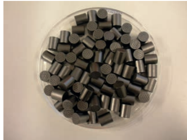
Ruutinäyte valmiina stabilisaattoripitoisuusmäärityksen esikäsittelyä varten. (Kuva: Tiina Runsas)
