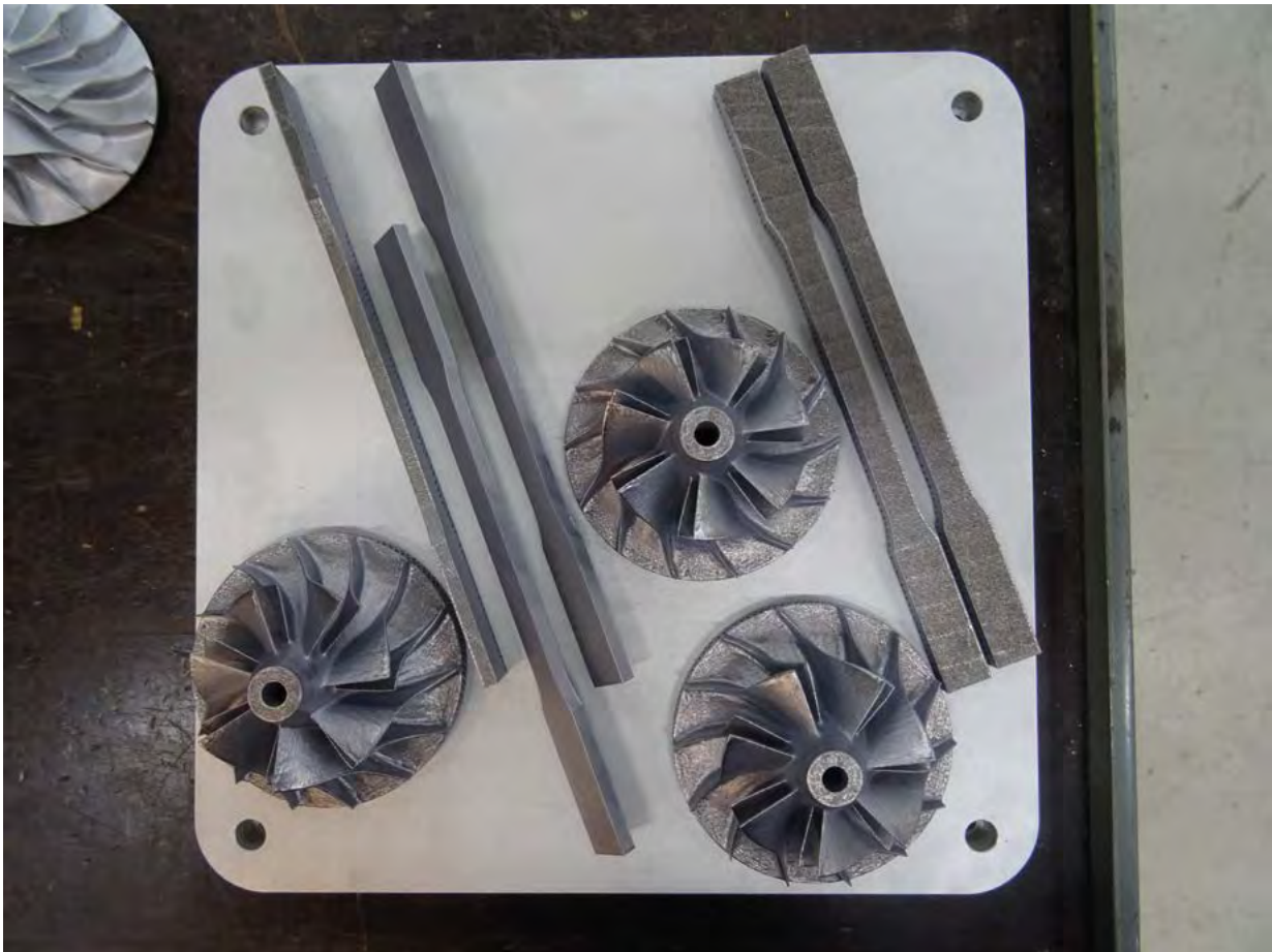
Kuva 2. 3D-tulostetut kappaleet valmiina irrotettavaksi tulostusalustalta. (Kuva: Mervi Hokkanen)
