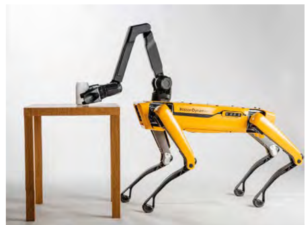
Kuva 5. Boston Dynamicsin kehittämä MiniSpot on pieni 25-kiloinen robotti, joka pystyy tarttumaan esineisiin ja kiipeämään portaita. (Kuva: https://www.bostondynamics.com )
