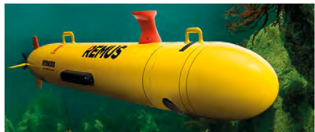
Kuva 2. Remus 100 AUV tehtäväänsä suorittamassa. (Kuva: https://www.km.kongsberg.com )
