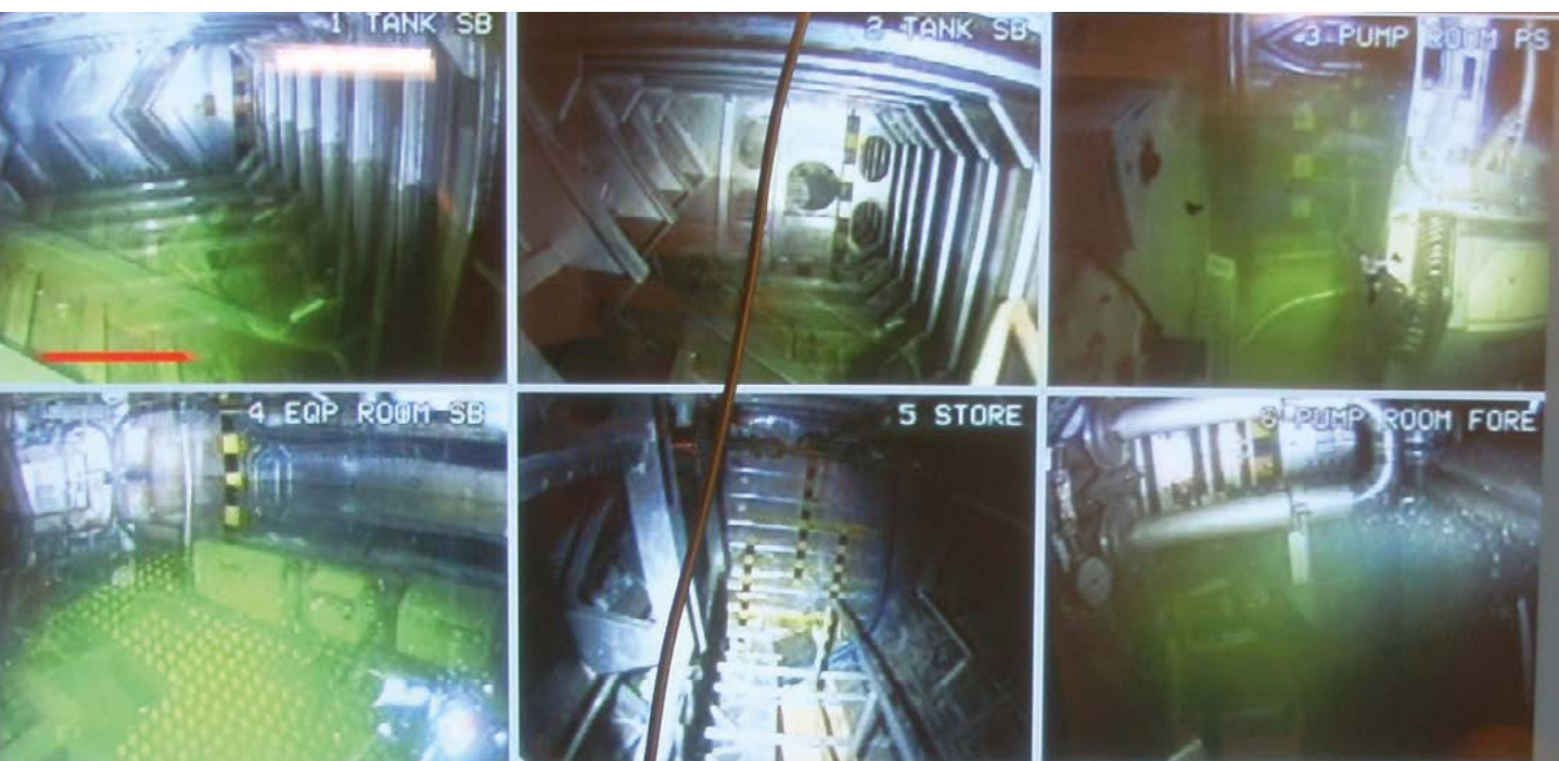
Kuva 2. Helsinki-luokan käytöstä poistetulla ohjusveneellä tehdyt vuotokokeet. Kuvat ovat valvontakameroiden näytöistä. (Kuva: Jarmo Harras)
