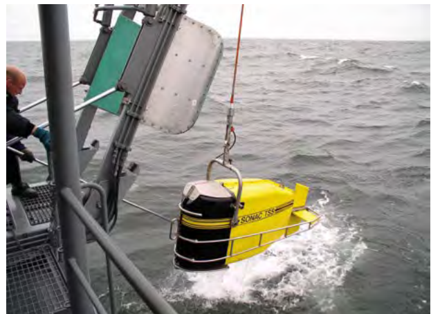
Vedenalaista äänilähdettä nostetaan koetoiminta-alus Iskun peräkannelle. (Kuva: Ari Poikonen)
