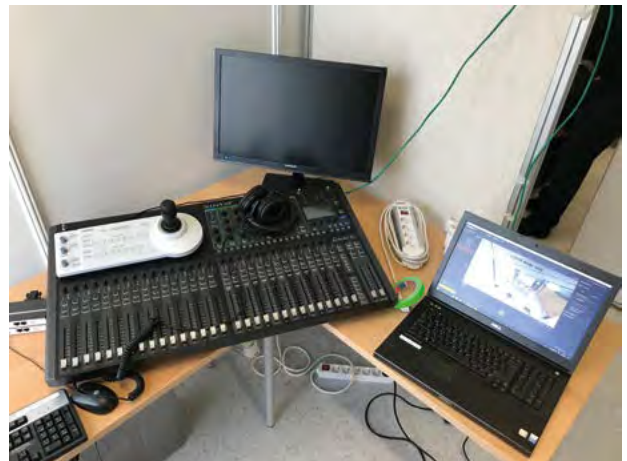
Kuva 3. Operaatiokeskuksen puhe nauhoitettiin usealla mikrofonilla, jotka reititettiin äänipöydän kautta tietokoneeseen. (Kuva: Pentti Haddington)
