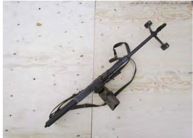
Kuva 3. Suomalainen 7.62 konekivääri 62 (7.62 kk 62) vyölaukku kiinnitettynä.
