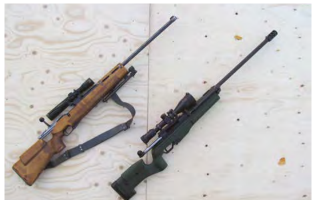
Kuva 5. Yllä yhä käytössä oleva tarkkuuskivääri M/85 (7.62 tkiv 85), ja sen alla on 8.6 tarkkuuskivääri 2000 (8.6 tkiv 2000).
