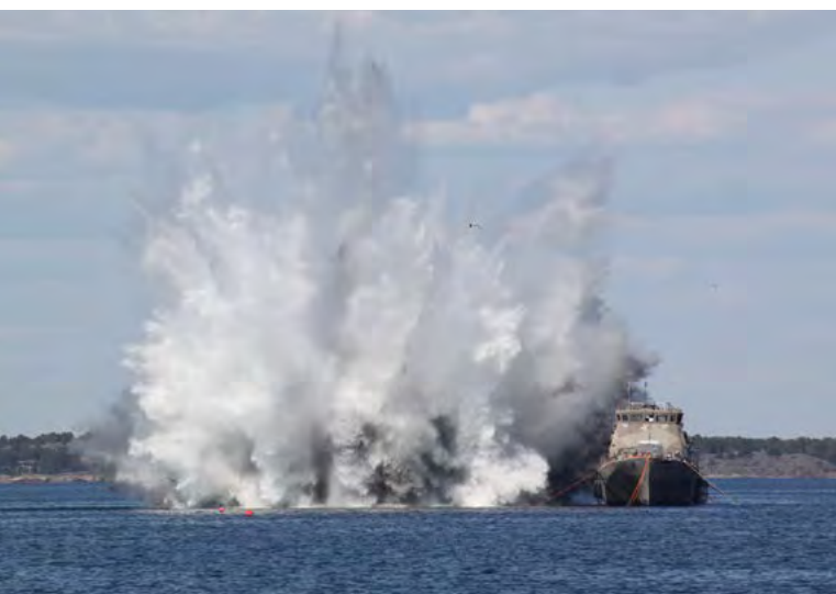
Vedenalaisen taistelunkestävyyden koetoimintaa: vedenalainen räjähdys käytöstä poistetun Helsinki-luokan ohjusveneen vieressä. (Kuva: Merisotakoulun kuva-arkisto)
