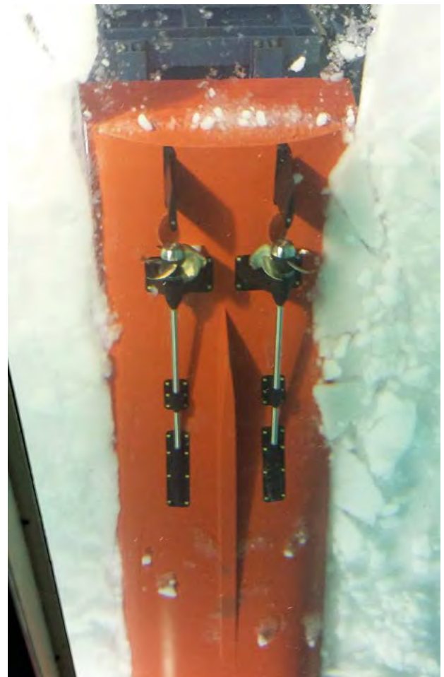
Kuva 1. Runkomuodon testausta mallilla jäämallikoelmaassa. Kuva on otettu aluksen alapuolelta. (Kuva: Jarmo Harras)
