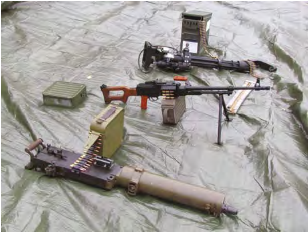
Kuva 6. Konekiväärien kehityskaari: etualalla on MAXIM-konekivääri, sen yläpuolella PKM-konekivääri ja kuvan ylälaidassa on Dillon M134 kuusipiippuinen konekivääri. Huomaa vyölaukkujen/ patruunakannujen patruunamäärien eroavaisuudet; tämä vaikuttaa suoraan tulituen kestoan.
