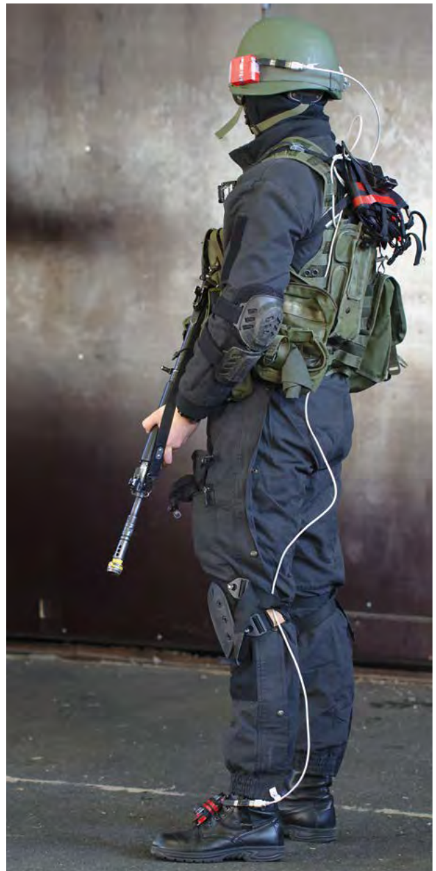
Kuva 1. Infrastruktuurista riippumattomassa paikannuksessa käytettävät anturit kiinnitettynä taistelijan varusteisiin. (Kuva: Martti Kirkko-Jaakkola)
