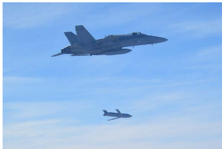
Kuva 1. AGM-158A JASSM -integraatio toteutettiin Yhdysvalloissa China Laken tukikohdassa Kaliforniassa. Kuvassa Suomen ilmavoimien ensimmäinen AGM-158A JASSM ohjuksen koelaukaisu. (Kuva: US Navy)
