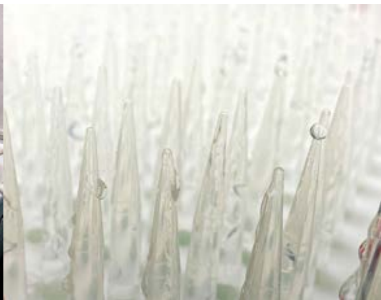
Kuva 4. Pesunesteet painettiin letkupumpulla alhaalta ylöspäin. Kuvassa on suodattimellisia pipetinkärkiä, joita käytetään käsin pipetoinnissa. (Kuva: Markku Mesilaakso)
