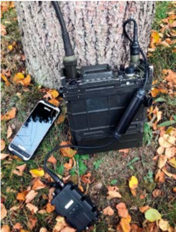
Kuva 1. MATI2TSTJJ yhdistettynä taktiseen verkkoon. Kuvassa Android-päätelaite, LV241-kenttäradio ja taistelijan reititin. (Kuva: Puolustusvoimat)
