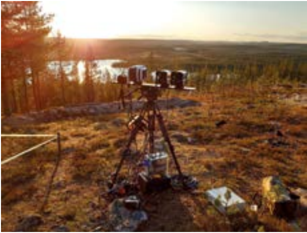
Kuva 2. Lämpö- ja suurnopeuskameroita mittauspaikalla. (Kuva: Matti Kajala)
