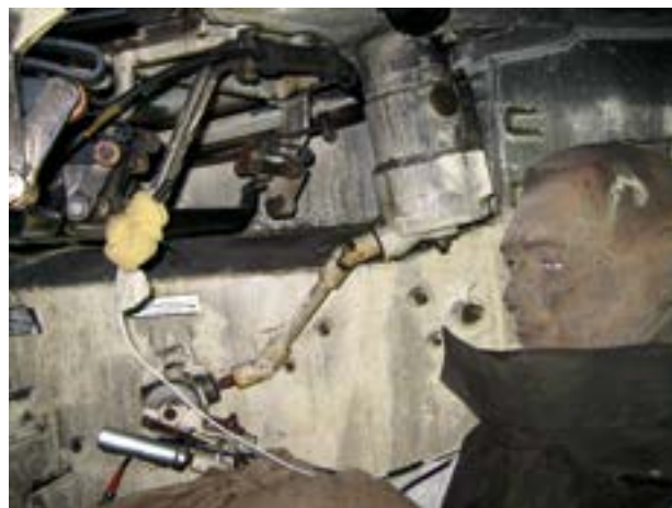
Paineanturi asennettuna. Pehmeuste estää osuman aiheuttamaa tärähdystä sotkemasta mittauksia. (Kuva: Markus Lehtonen)
