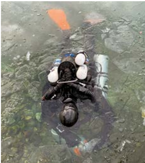
Suomalainen suljetun kierron laitteella sukeltava tekniikkasukeltaja aloittamassa jäänalaista sukellusta Ojamon kaivoksella alkukevällä 2020. Sukeltajalta mitattiin sukelluksen aikana mm. ihon pintalämpöä ja sykevälivaihtelua. Lisäksi hän suoritti veden alla valppautta ja reaktioaikaa mittaavan Critical Flicker Fusion Frequency -testin. Ennen sukellusta ja sukelluksen jälkeen tehtiin myös paljon muita mittauksia, mm. sydämen ultraäänitutkimuksia. (Kuva: Richard Lundell)
