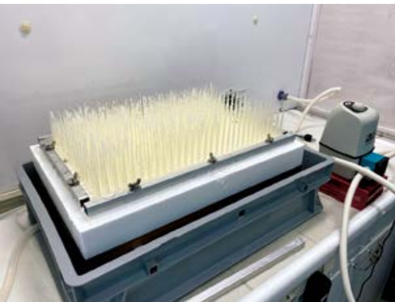
Kuva 3. Pipetinkärjet asetettuina pesulaitteeseen terävä kärki ylöspäin. Neste virtaa pesuliuosastiasta kalvopumpun avulla aluksi täyttämään pesulaitteen alaosan ja sen jälkeen pipetinkärkien läpi. (Kuva: Markku Mesilaakso)
