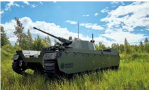
Esimerkki raskaan kokoluokan UGV-ajoneuvosta (virolaisen Milrem Robotics -yhtiön Type-X). (Kuva: Milrem Robotics)
