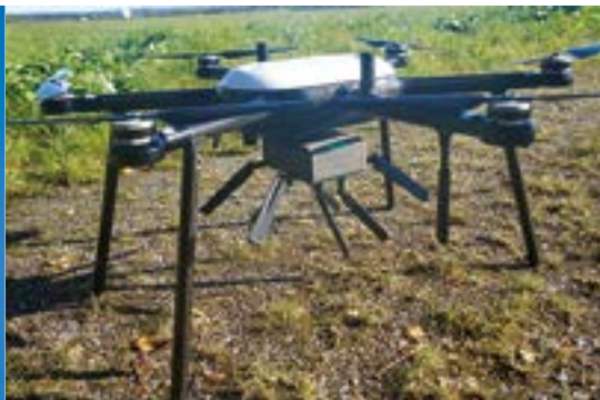
Kuva 4. Multikopteri WLAN-tukiasema kyydissään. (Kuva: Mika Nieminen)
