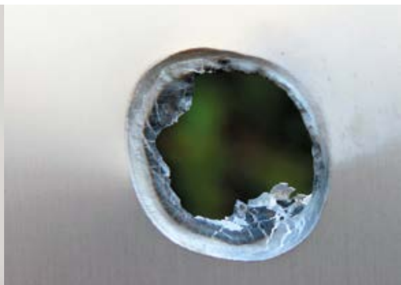
Kuva 3. Laserilla alumiinilevyyn sulatettu reikä. (Kuva: Tomi Parviainen)
