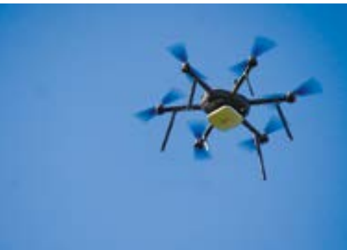
Kuva 3. Multikopteri radioläheteiden havaitsemislaite mukanaan. (Kuva: Tapio Haapamäki)
