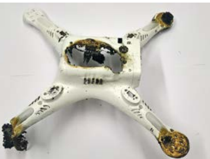
Kuva 2. Dronin runko laserin staattisen polttokokeen jälkeen. (Kuva: Sini Kivi)
