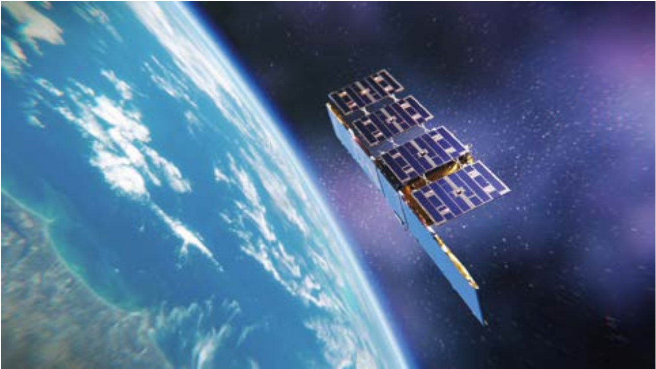
Kuva 2. Iceyen SAR-tutkasatelliitti. Satelliitit kiertävät noin 600 km:n korkeudessa. Kuvassa maata kohti olevat levyt ovat vaiheistettuja tutka-antenneja. Satelliitin voimanlähteenä olevia aurinkopaneeleita näkyy myös kuvassa. (Kuva: Iceye Oy, julkaistu luvalla)
