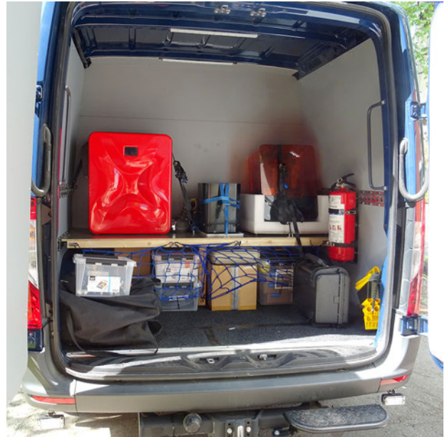
3D-tulostusajoneuvon takaosaosa, jossa PBF-tulostin, SLA-tulostin sekä näiden menetelmien jälkikäsittelytarvikkeet. (Kuva: Mervi Hokkanen)
