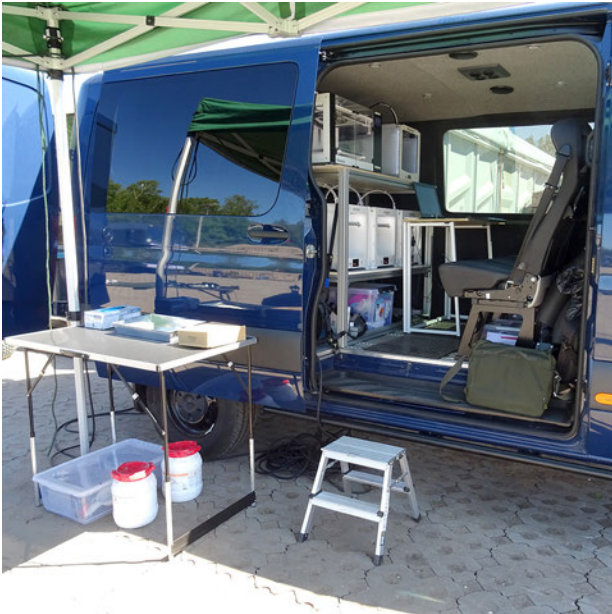
3D-tulostusajoneuvon keskiosa, jossa paikat kahdelle mallinnusasemalle ja viisi FDM-tulostinta. (Kuva: Mervi Hokkanen)
