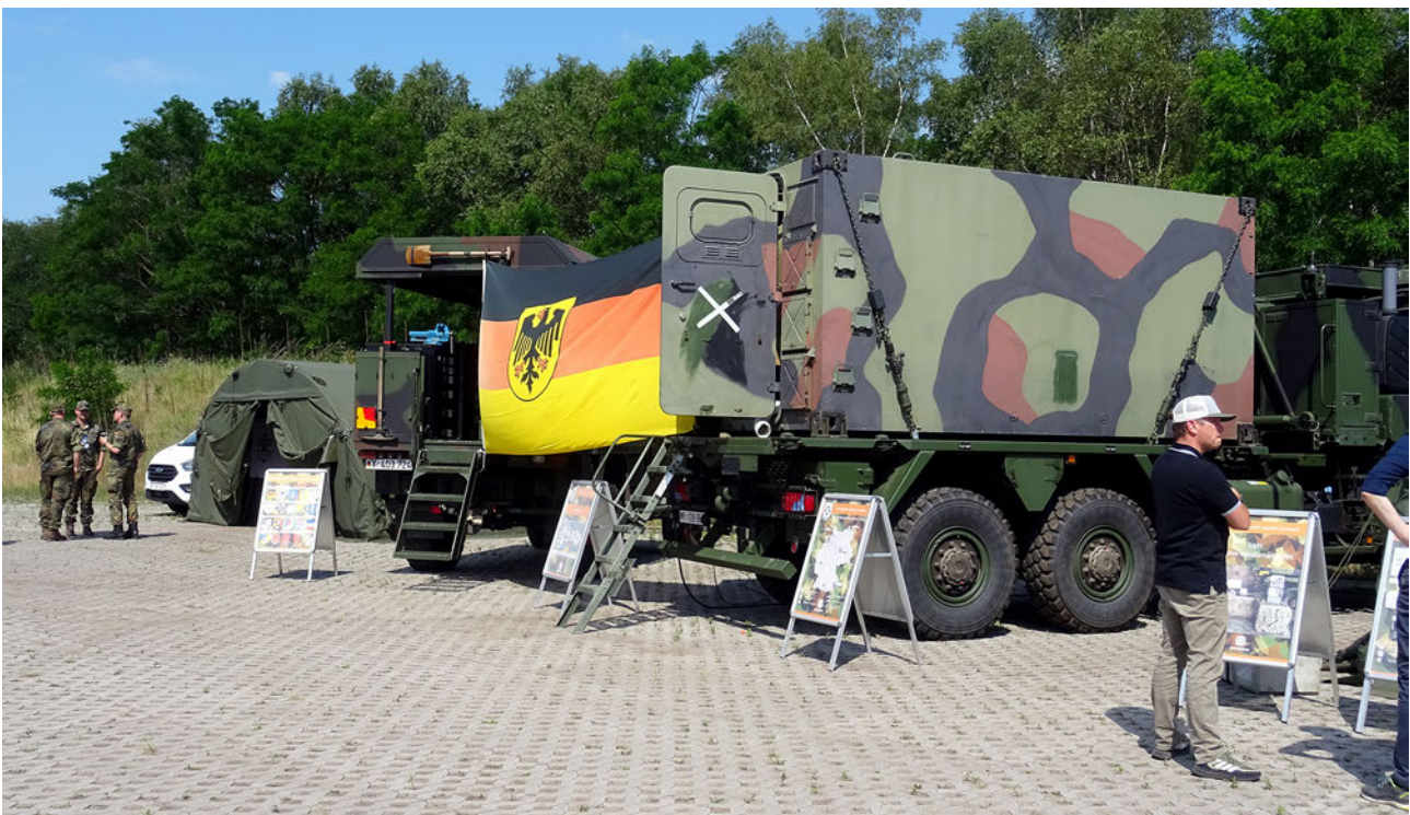
Kuva 1. Ajoneuvon kyydissä kuljettavaan konttiin rakennettu saksalaisten 3D-tulostuskyvykyys. (Kuva: Mervi Hokkanen)
