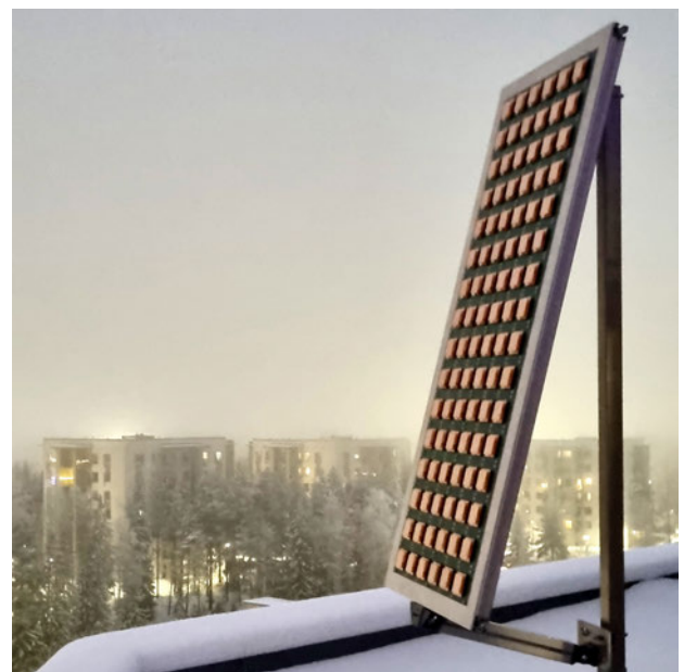
Kuva 1. Yksipaikkaisen kohinatutkan antenniryhmä valvomassa yliopiston kampuksen ilmatilaa. (Kuva: Mikko Heino)
